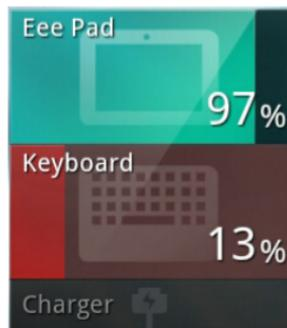
4. A Configuração Rápida ASUS e o painel de notificação exibem também o estado da bateria. O estado da bateria do ASUS Transformer Pad e da estação de ancoragem são exibidos separadamente. Quando a bateria estiver fraca, a cor do ícone da bateria passará de azul para vermelho acompanhado de um ponto de exclamação. Será também emitido um som de aviso para alertar o utilizador quando a carga da bateria estiver a terminar.
